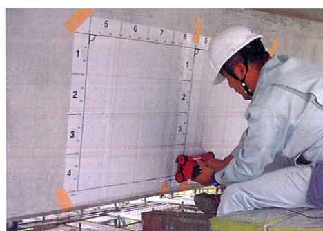
使用例2：橋梁上部工探査に (ブロックスキャンによる鉄筋かぶり厚の確認)
