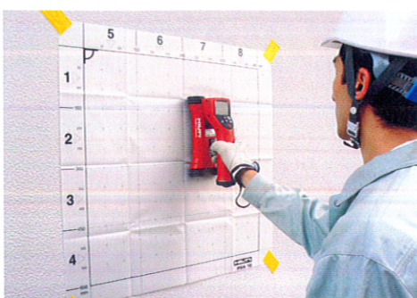
使用例1：建築物の構造確認に (イメージスキャンによる鉄筋位置・本数・かぶり厚の確認)
