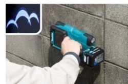
ブロック内の空洞と鉄筋など、探知対象が一種類ではない探知に。
